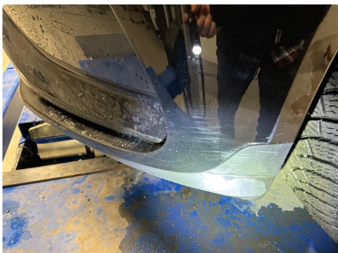
1.3 Ripe(r) ned til grunning
