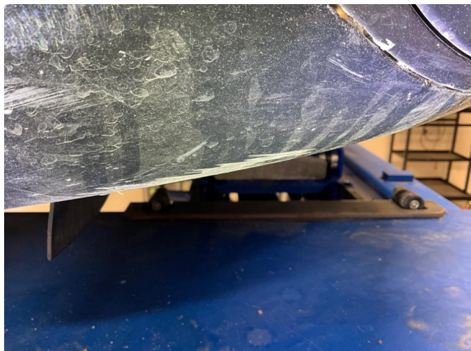
1.1 Ripe(r) ned til grunning
