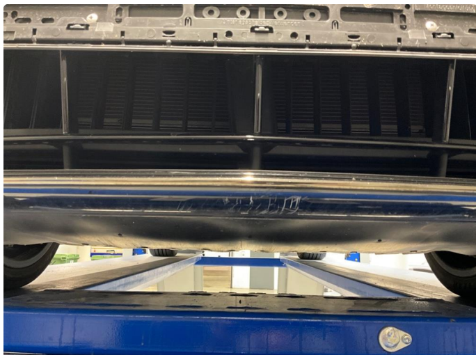
1.1 Ripe(r) ned til grunning
