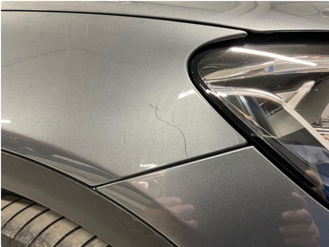
1.1 Ripe(r) ned til grunning
