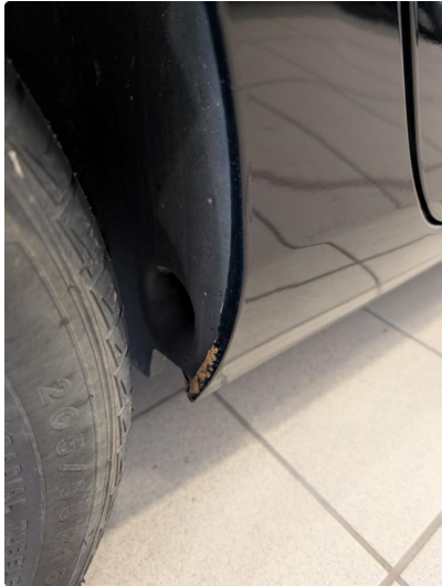
2.1 Rust i hjulbue
