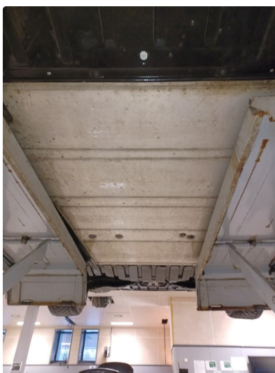
1.2 Understell og batteri kontrollert
