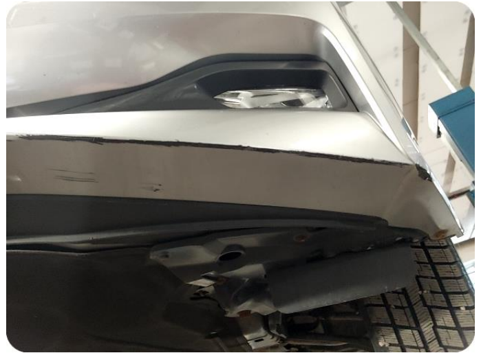
1.2 Skrubbskader underkant Fanger foan
