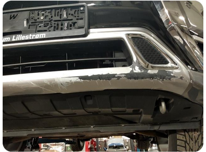
1.3 Skrubbskader underkant Skade/riper fanger foran
