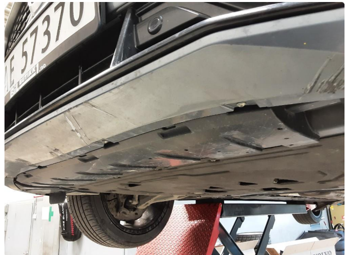
1.3 Ripe(r) ned til grunning
