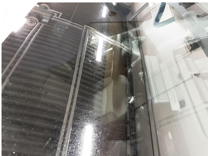
1.1 Noen Steinsprut i frontrute
