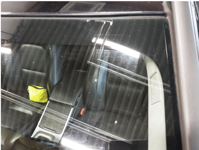
1.3 Noen steinsprut og merker etter pusser
