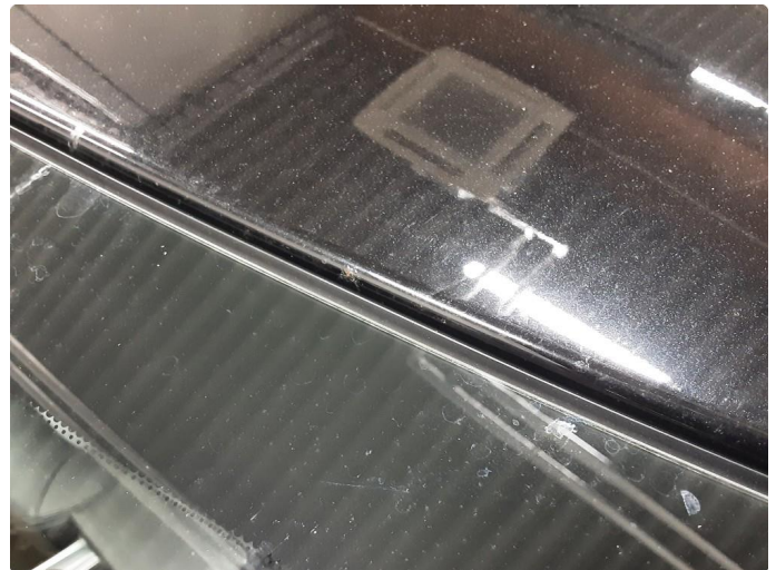
1.3 Steinsprut med rust
