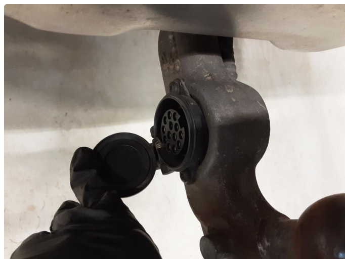
1.2 Tilhengerkontakt- innfesting skadet
