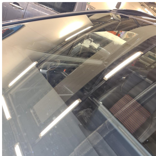
1.1 Noen steinsprang i frontrute
