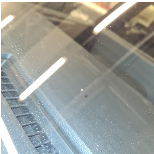
1.1 Noen steinsprang i frontrute
