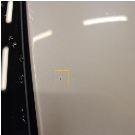
1.3 Steinsprut med rust på tak, venstre side foran
