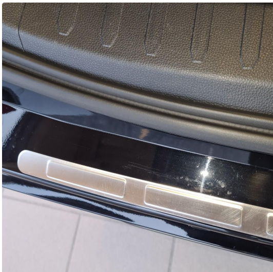
1.1 Riper på støtfanger, bak
