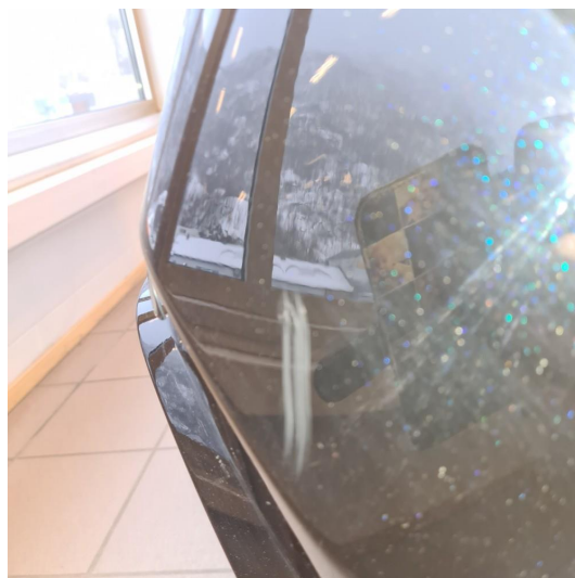
1.1 Riper på støtfanger, bak
