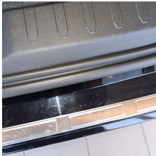
1.1 Riper på støtfanger, bak
