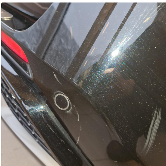
1.1 Riper på støtfanger, bak
