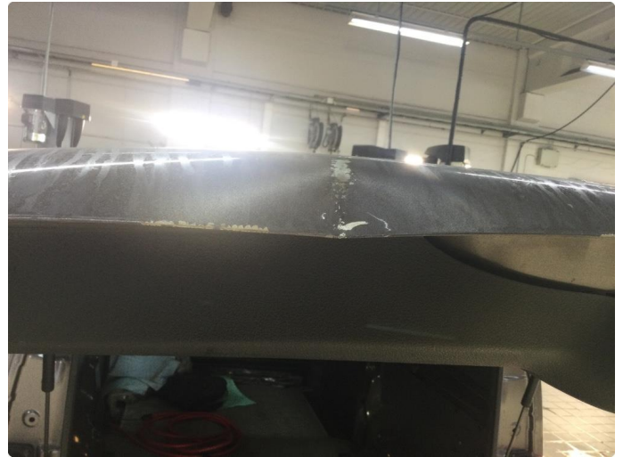
1.1 Bulk med lakkskade
