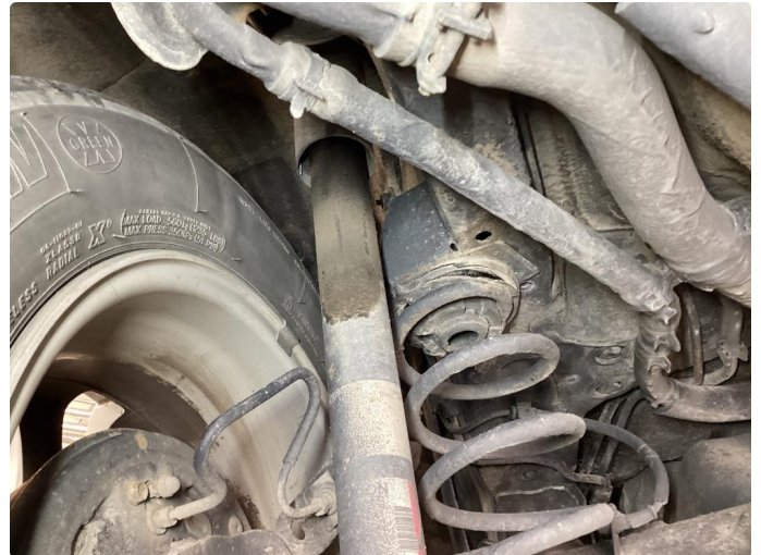
2.1 Begynnende svetting støtdemper bak, ikke mangel PKK
