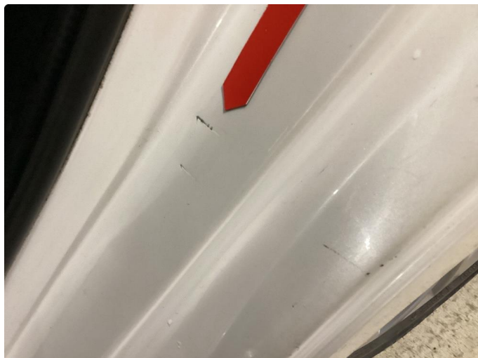
1.2 Bulk(er) med lakkskade
