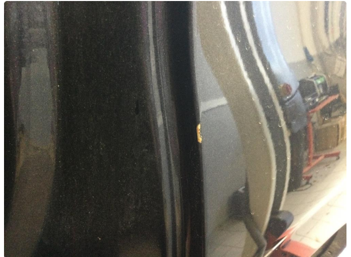
1.2 Steinsprut med rust
