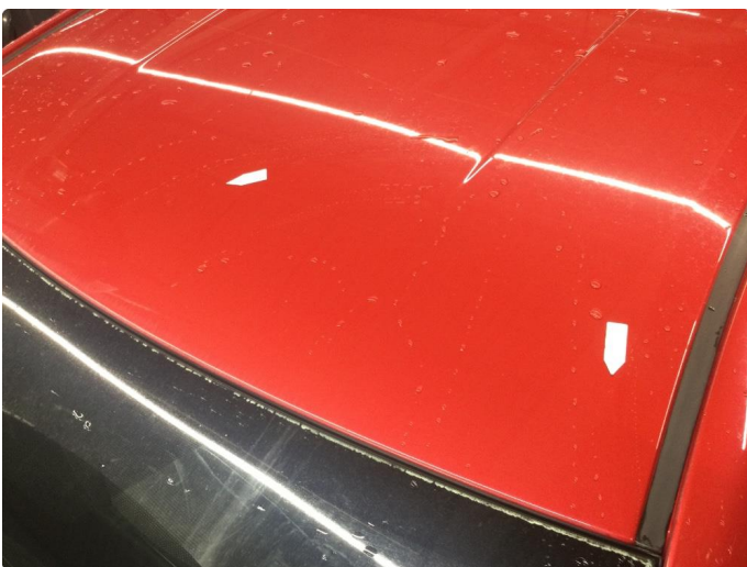
1.2 Steinsprut med rust
