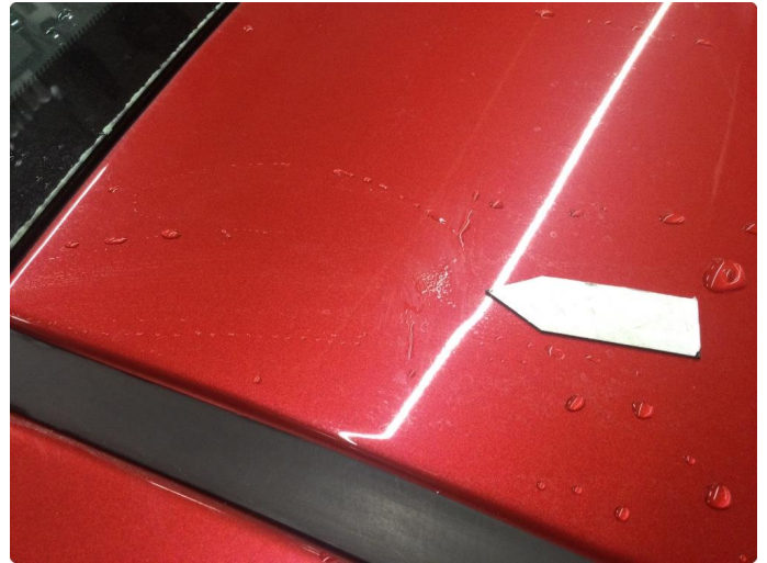
1.2 Steinsprut med rust
