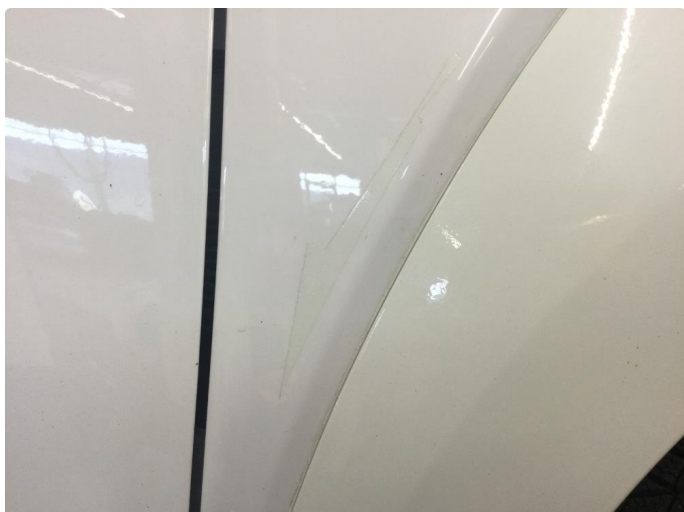
1.1 Noe farge forskjell på hjulbuelist høyre foran.
