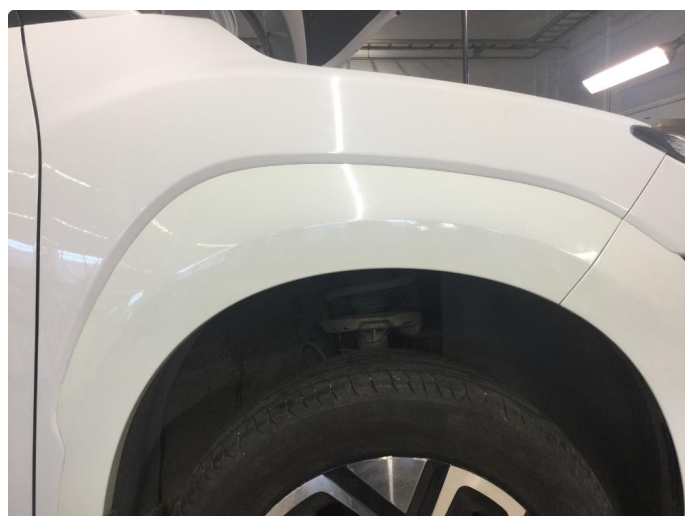
1.1 Noe farge forskjell på hjulbuelist høyre foran.
