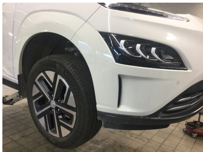
1.1 Noe farge forskjell på hjulbuelist høyre foran.
