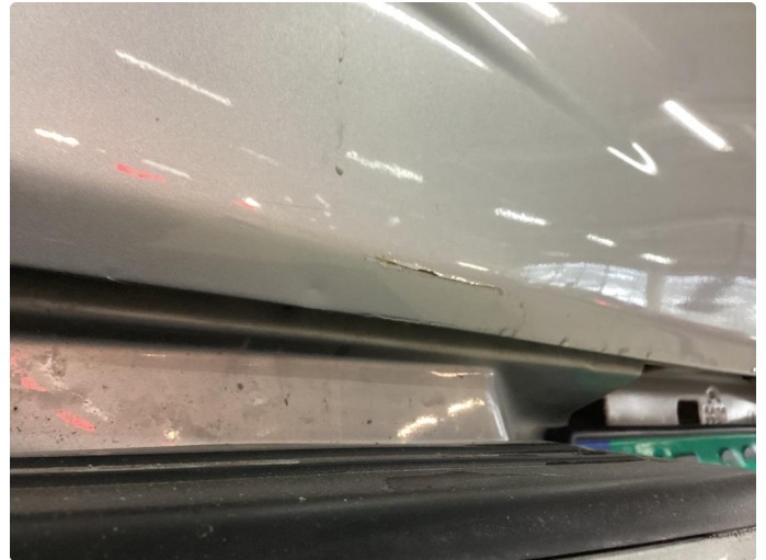
1.1 Liten sprekk i lakk nederst bakluke
