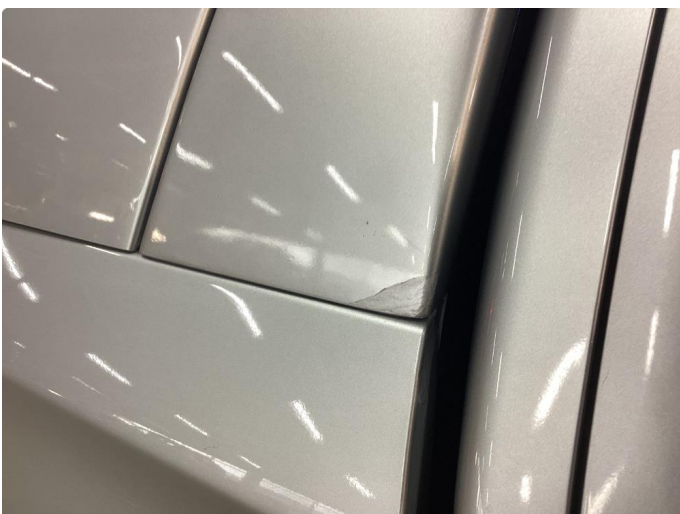
1.2 Liten flekk på topp hvor lakk er borte, venstre fremkant nederst (Denne er laget i glassfiber og har sammenlignbar grunnfarge)
