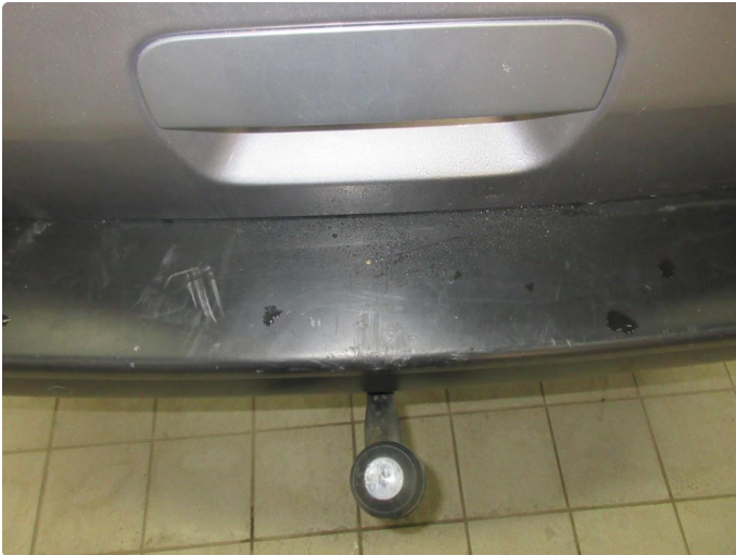
1.1 Ripe og liten sprekk på støtfanger ved innlasting v.side
