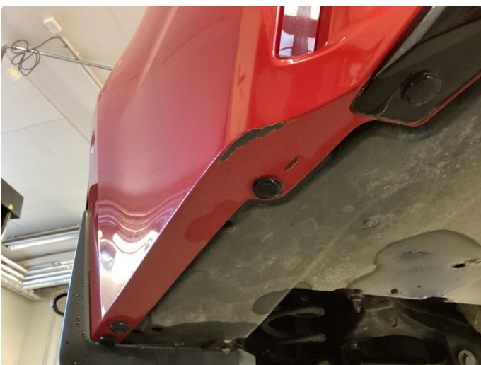
1.4 Skrubbskader underkant på støtfanger bak.
