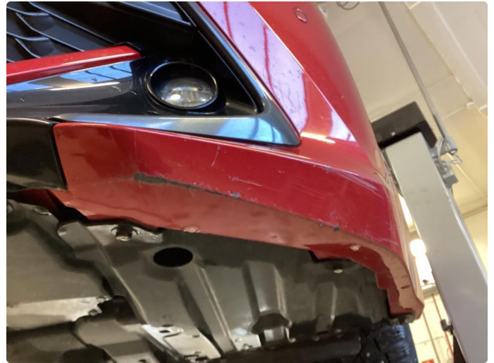
1.3 Skrubbskader underkant på støtfanger foran.
