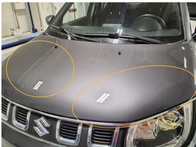
1.1 Noe steinsprut panser
