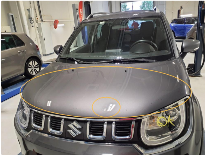
1.1 Steinspurtskader panser, behandlet.
