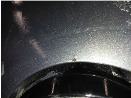
1.1 Noe steinsprut med rustflekk
