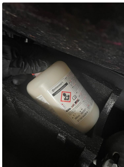
2.2 Dekktettermiddel utgått/mangler ( byttes )
