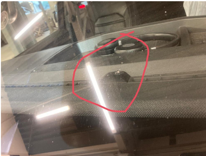
2.2 1 stk steinsprut frontrute pluss noen avskalinger.
