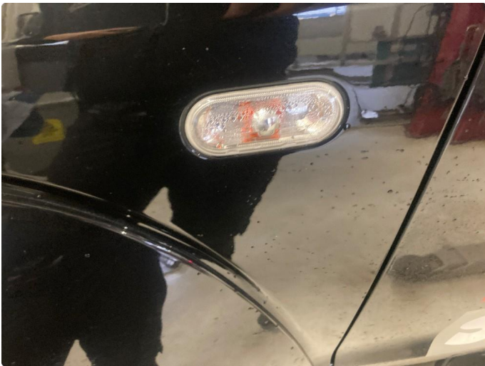
3.1 Vann i blinklys skjermer høyre og venstre
