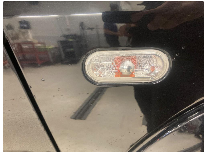
3.1 Vann i blinklys skjermer høyre og venstre
