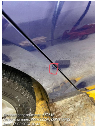
1.3 P-bulk Høyre bak og venstre framme
