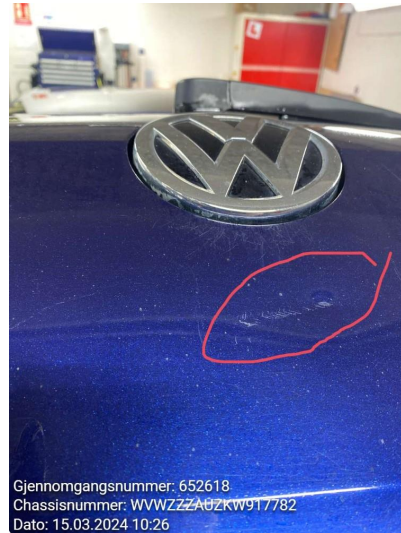
1.2 Bulk med lakkskade Rust rundt dreneringa
