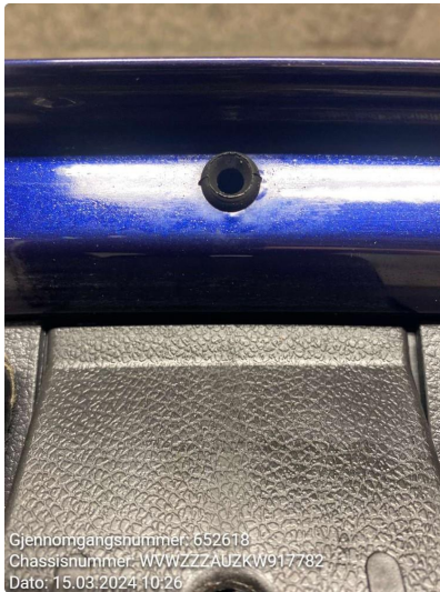
1.2 Bulk med lakkskade Rust rundt dreneringa
