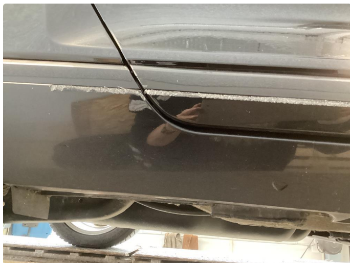
1.5 Riper nedre deksel högre bakdör over i kanal list
