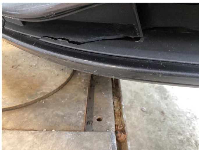
1.7 Sprekt stötfanger foran, og riper högre side
