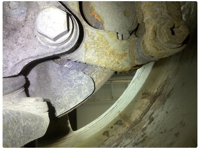
2.1 Rust bremsar foran
