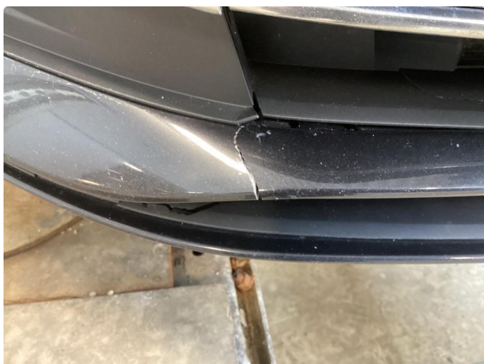
1.7 Sprekt stötfanger foran, og riper högre side
