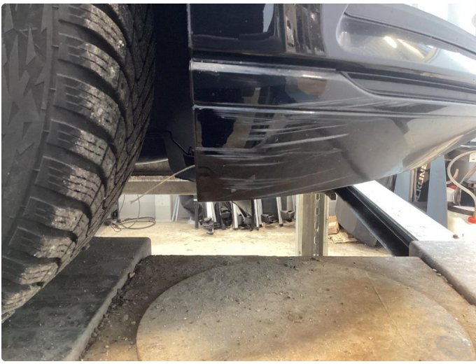
1.7 Sprekt stötfanger foran, og riper høyre side
