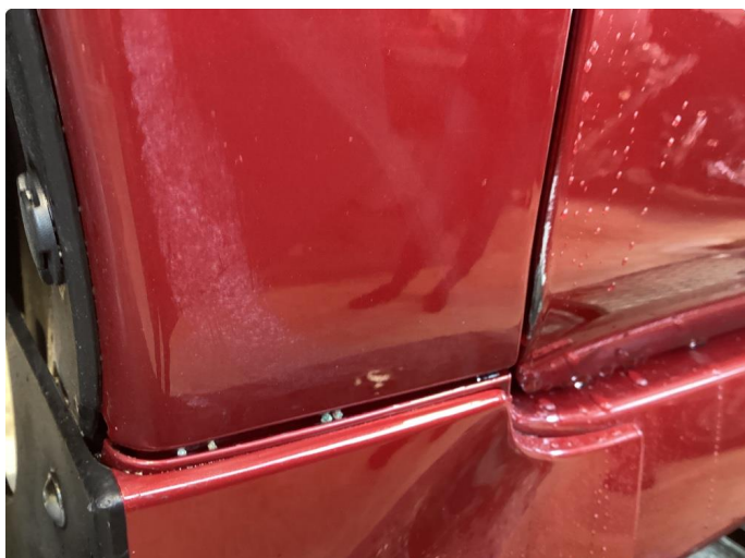
1.1 Slitt lakk venstre fordør
