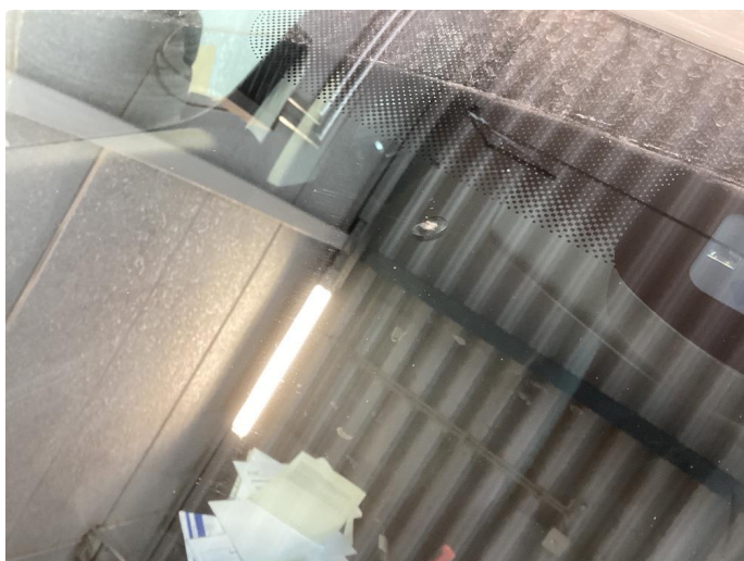
1.7 Frontrute har en del steinsprut, en med avskalling
