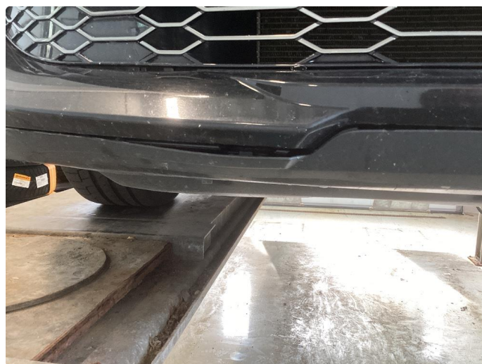
1.2 Skade stötfanger foran og innerskjerm høyre side, 2 felger.
