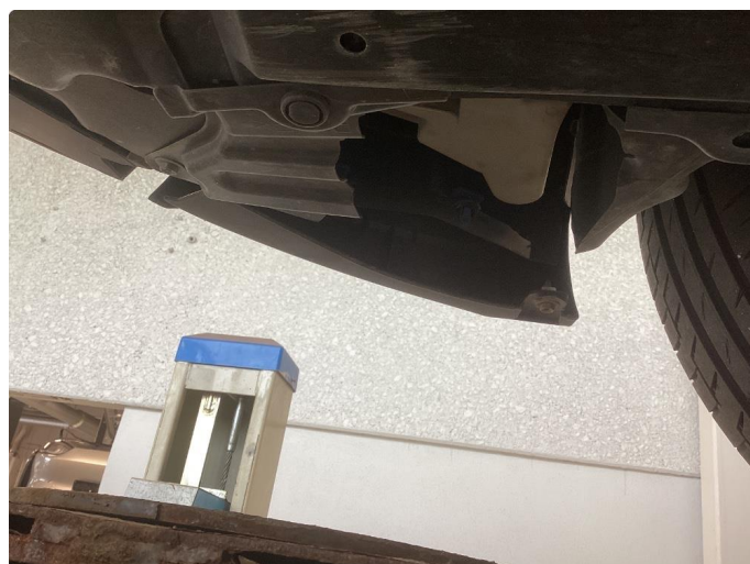
1.2 Skade støtfanger foran og innerskjerm høyre side, 2 felger.
