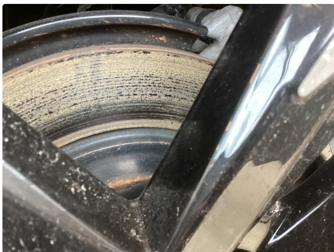
2.1 Rust bremsar bak
