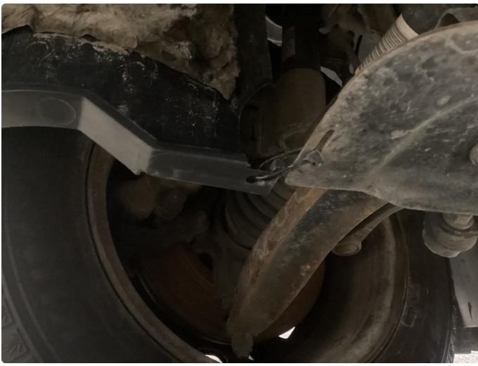
1.2 Noe skader innerskjermer /side deksler under motor
