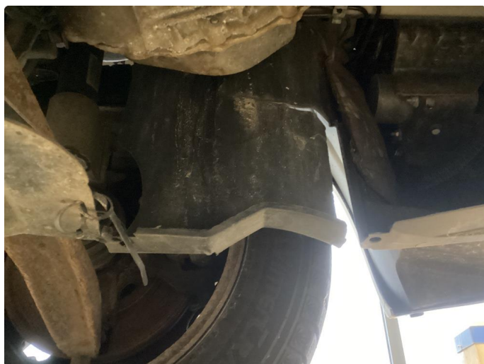
1.2 Noe skader innerskjermer /side deksler under motor
