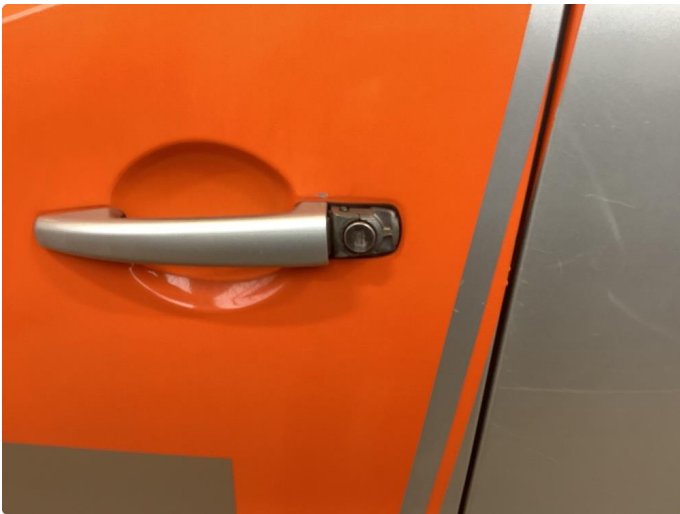
1.4 Cover over utvendig lås venstre fordör mangler
