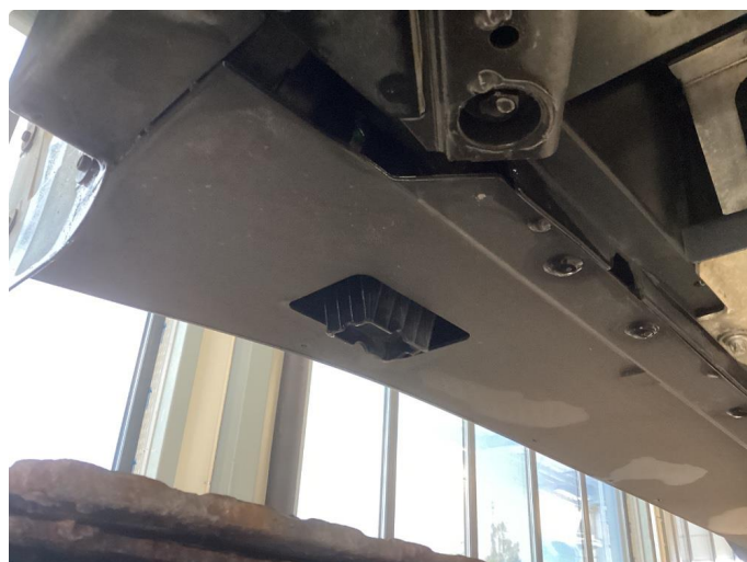
1.2 Mangler løfte paden høyre side bak
