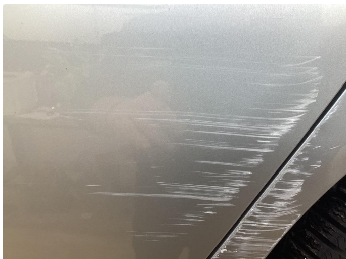
1.1 Skade venstre bakdør
