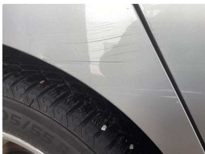
1.5 Skade høyre bakskjerm
