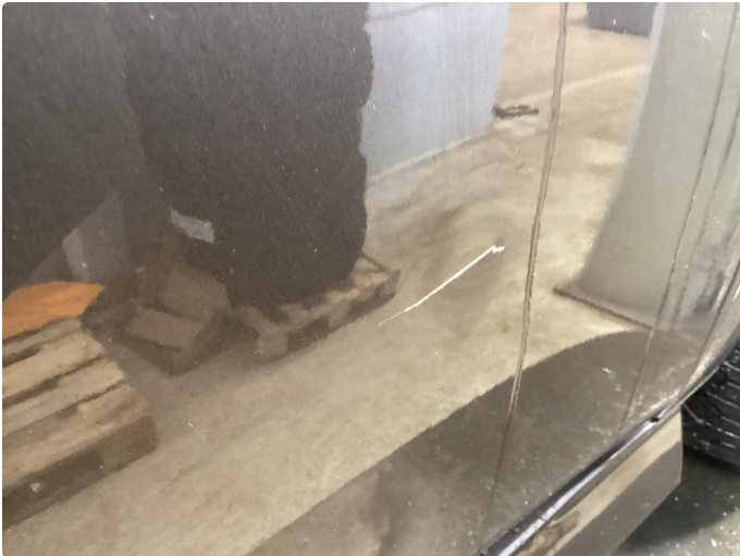
1.1 Skade høyre fordör
