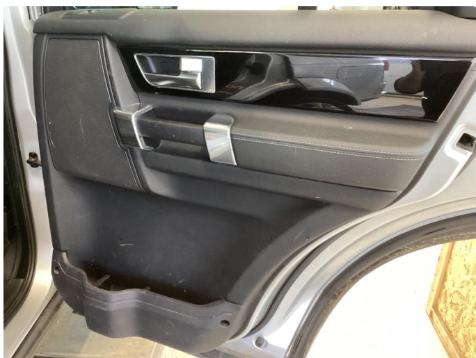
2.2 Mye merker og slitasje i dørtrekk begge sider bak
