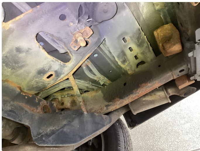
1.5 Rust under bil/ramme, er nok mest overflatisk
