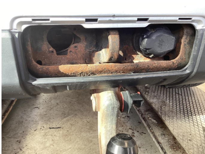
1.4 Noe rust bjelke bak fanger
