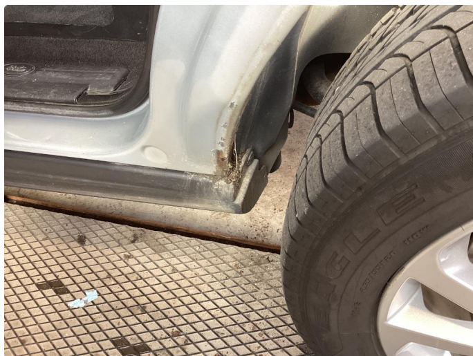
1.9 Rust begge hjulbuer bak. Nede inside bakdører
