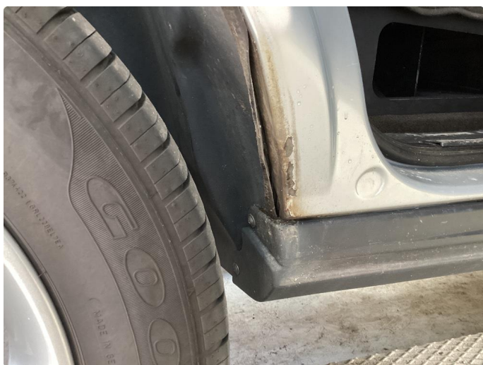
1.9 Rust begge hjulbuer bak. Nede inside bakdører
