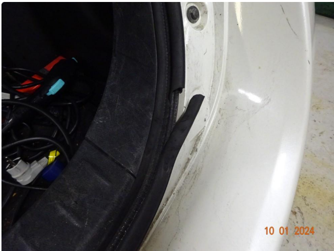
1.5 Tettelist til bagasje rom er revnet.
