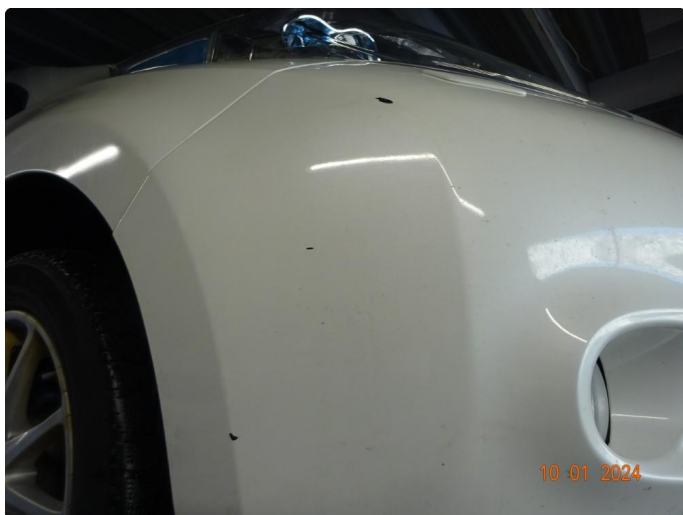
1.7 Hjørne foran h side er ripet opp og deformert front av fanger. . ripet under kant v side.
