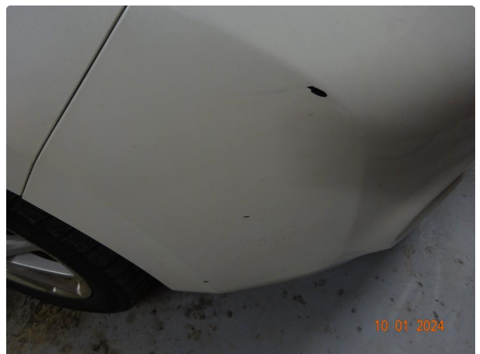
1.6 Fanger bak er deformert skadet midten bak. og hjørne bak er ripet opp
