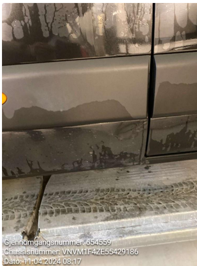
1.11 Mye bulker bak, midt å framme mellom dører høyre side
