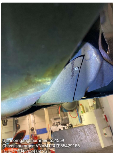
1.5 Plastinnerskjerm skadet Høyre side framme
