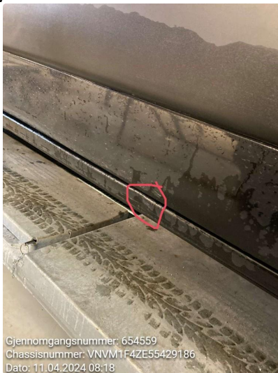
1.11 Mye bulker bak, midt å framme mellom dører høyre side
