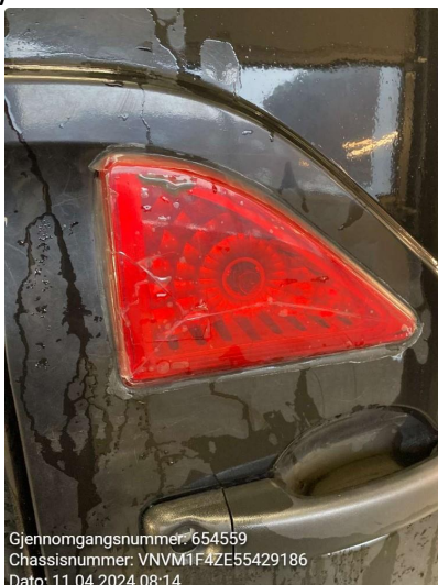
2.1 Venstre og midtre sprekt, høyre full av vann
