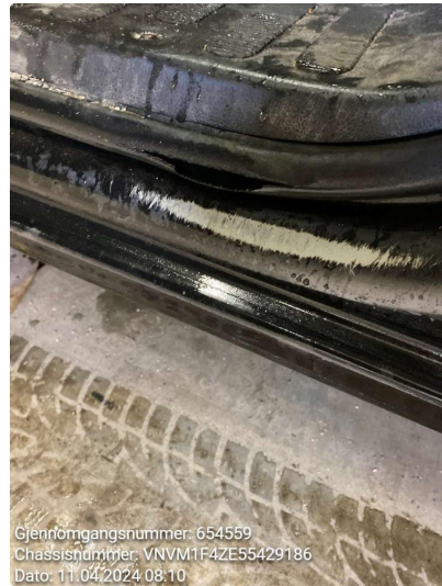
1.10 Bulk framme, utslitt i innsteg. bulk bak venstre side
