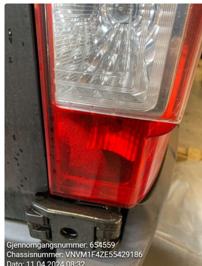
2.1 Venstre og midtre sprekt, høyre full av vann
