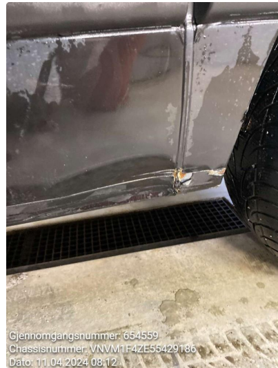
1.10 Bulk framme, utslitt i innsteg. bulk bak venstre side
