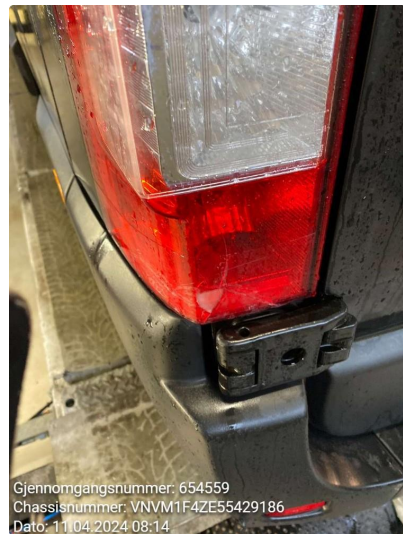
2.1 Venstre og midtre sprekt, høyre full av vann
