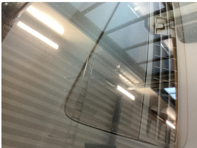
2.3 Slitt frontrute, noen steinsprut
