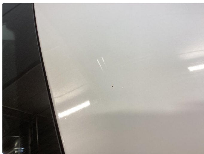
2.1 Noe steinsprut med rust på panser og tak.
