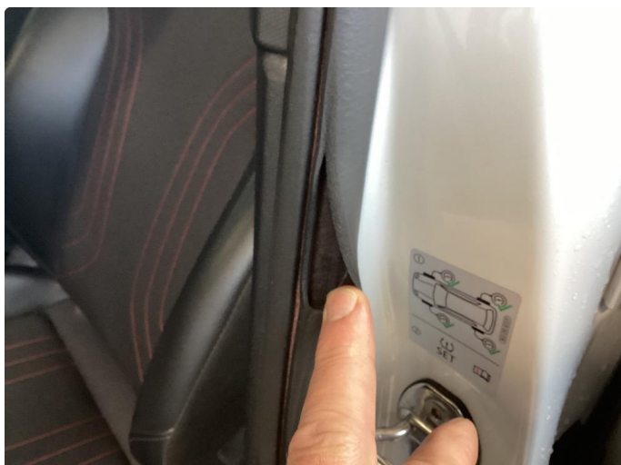
1.2 List dörkarm venstre fordør er defekt
