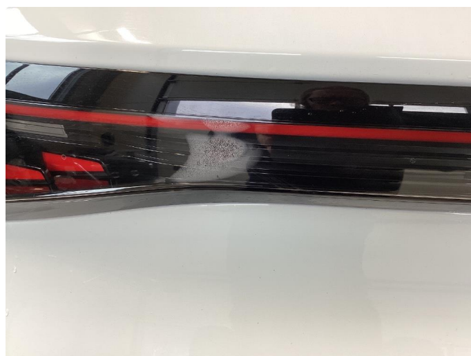
2.1 Noe fukt i lys list bak
