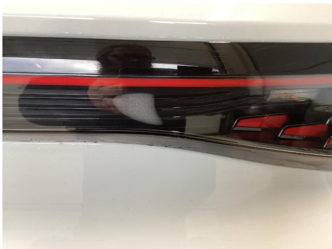
2.1 Noe fukt i lys list bak
