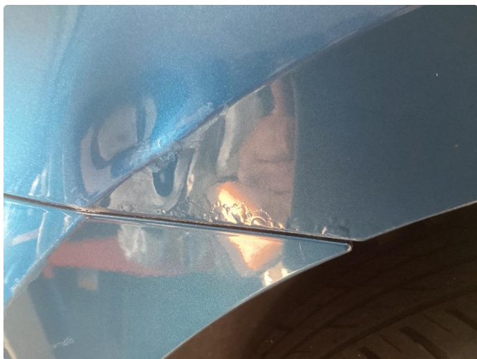
1.5 Skade og rust høyre bakskjerm
