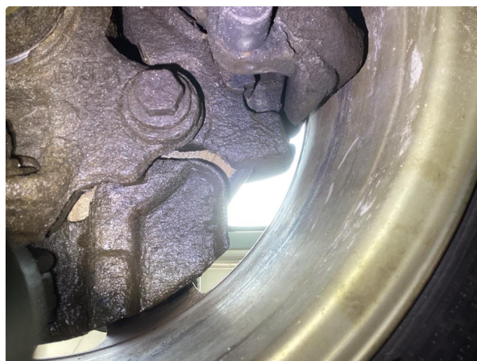
3.1 Slitte bremseskinne inni foran
