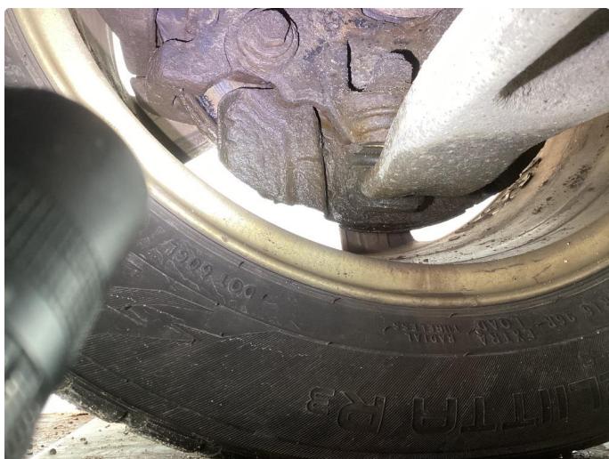
3.1 Slitte bremseskinne inni foran
