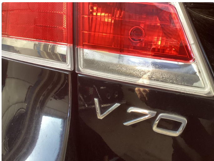
2.1 Noe fukt i begge indre baklykter
