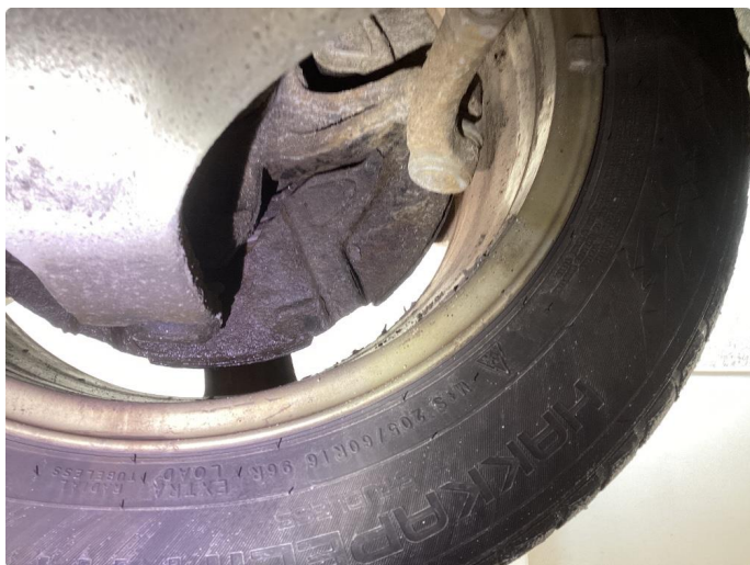
3.2 Mye rust bremseskjold foran, er porøse
