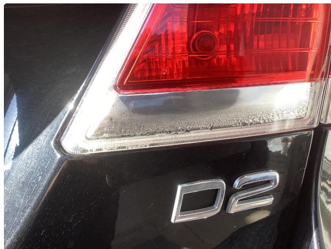
2.1 Noe fukt i begge indre baklykter
