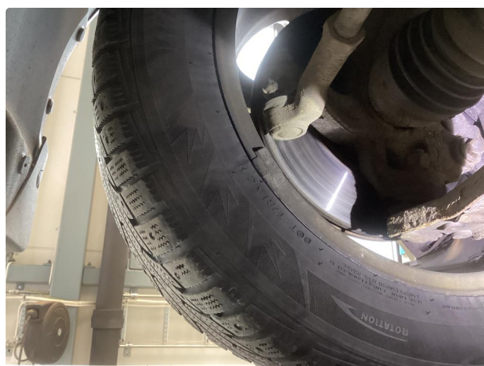
3.1 Mangler bremseskjold foran
