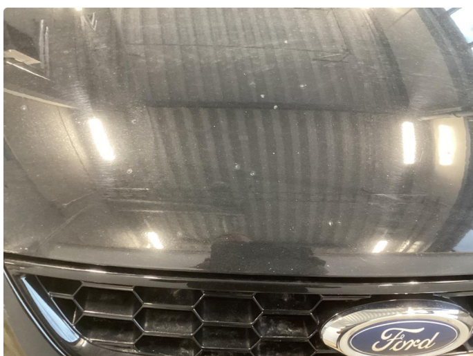
1.2 Panser har mye steinsprut som er flekket.
