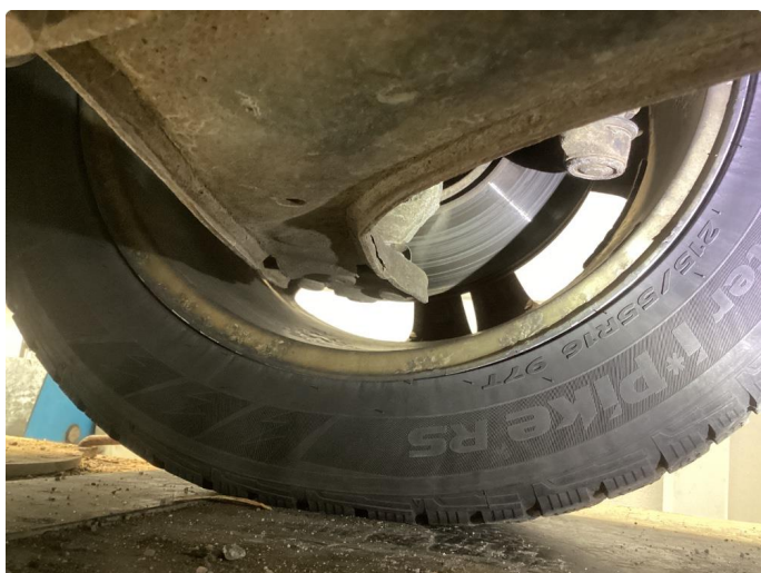
3.1 Mangler bremseskjold foran
