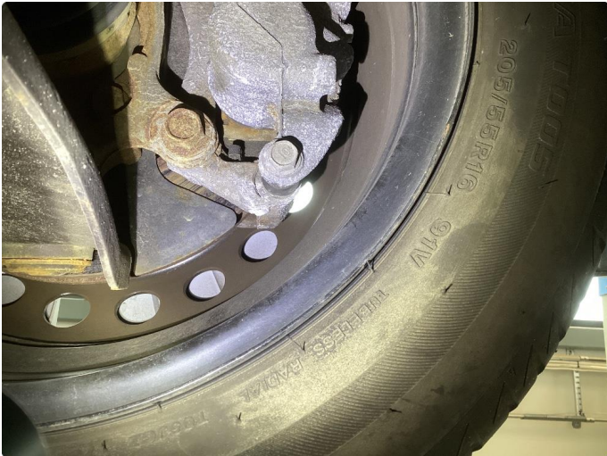
1.1 Påbegynt rust inside bremseser foran
