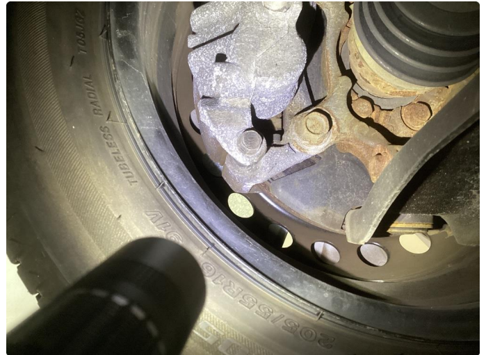
1.1 Påbegynt rust inside bremseser foran
