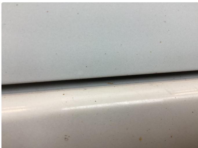
1.1 Noen små sinkslipp venstre fordör
