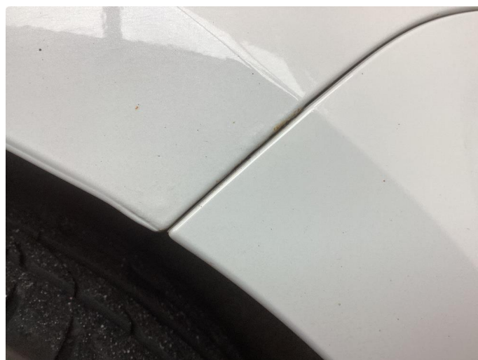
1.2 Rust begge bakskjermer
