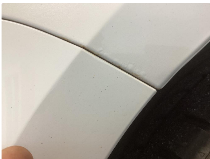
1.2 Rust begge bakskjermer
