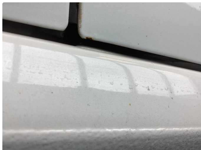
1.1 Noen små sinkslipp venstre fordör
