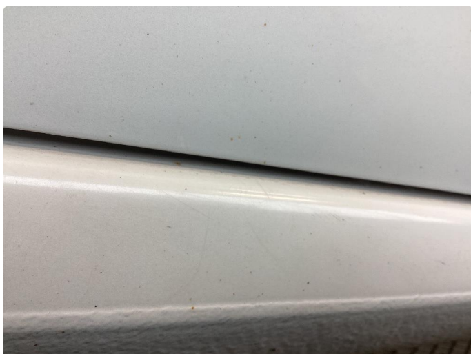
1.1 Noen små sinkslipp venstre fordör
