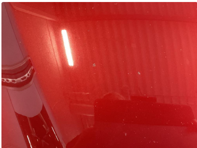
1.3 Mye steinsprut panser og framkant tak
