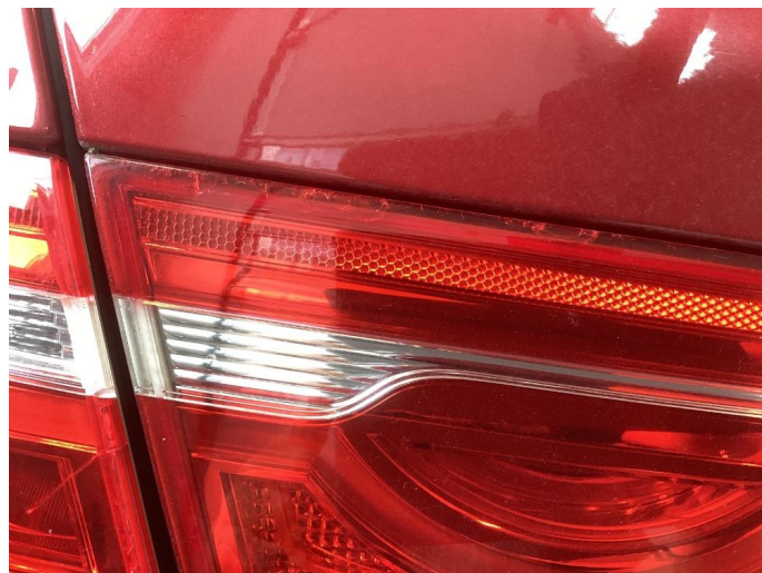
2.1 Begge indre baklykter er krakkelerte
