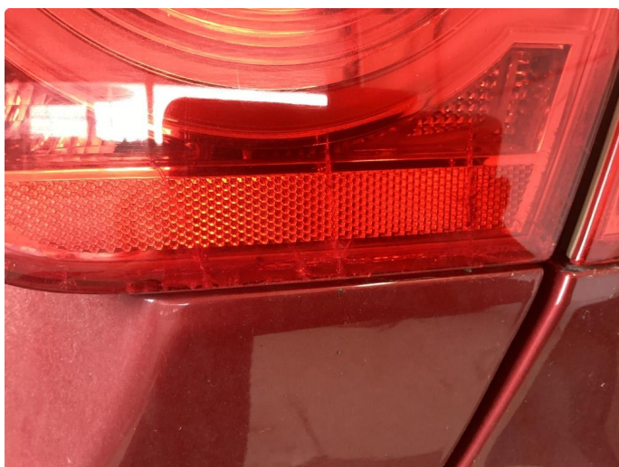
2.1 Begge indre baklykter er krakkelerte
