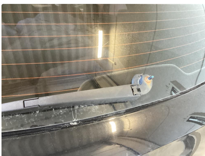
1.5 Mangler deksel over spyler bak
